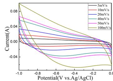
根据循环伏安曲线容量计算公式： $C_m = \frac{1}{S \times m \times \Delta V} \int_{V_0}^{V_0+\Delta V} idV$
