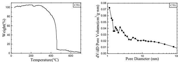
图2. 昂星CTG产品TGA分析和孔径分布分析
